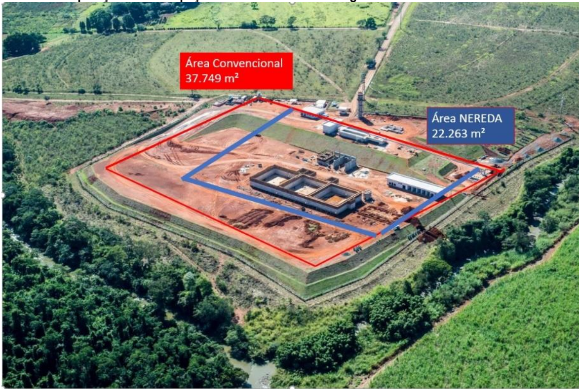
Figura 2 Comparação entre ocupação de área entre a Tecnologia NEREDA e as convencionais
