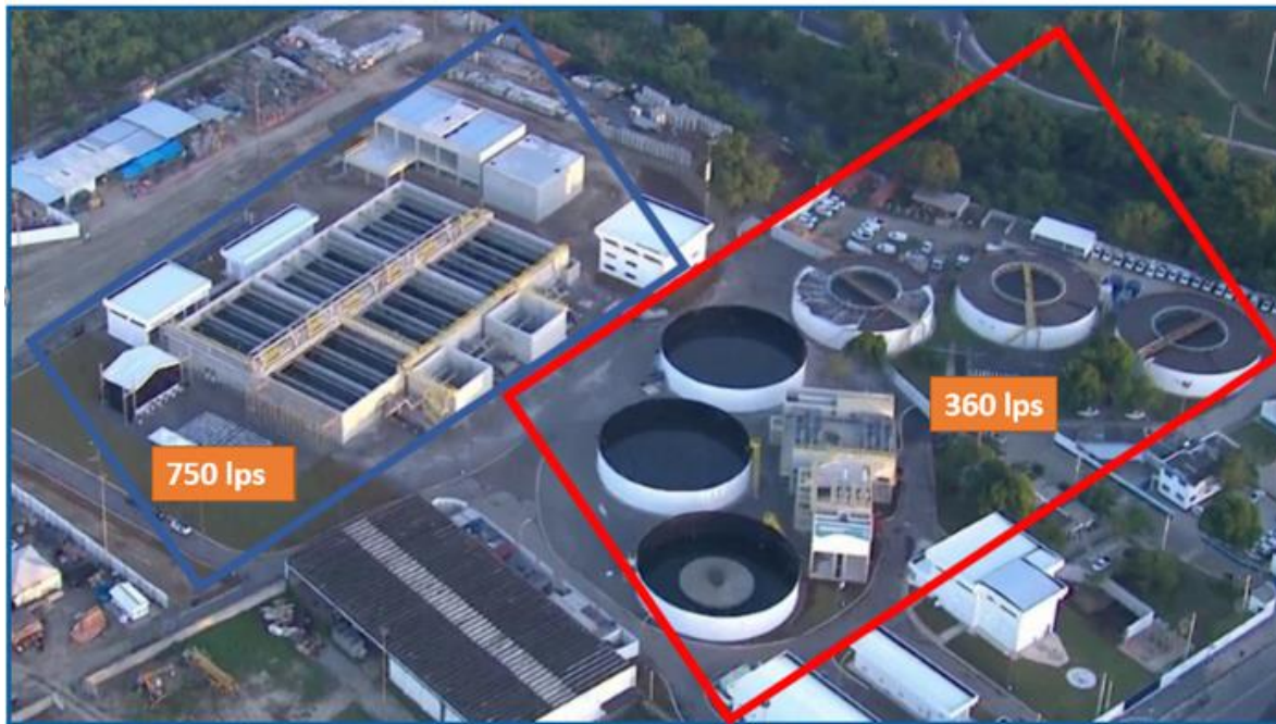
Figura 3 Comparação entre capacidade de vazão x área entre a Tecnologia NEREDA e as convencionais
