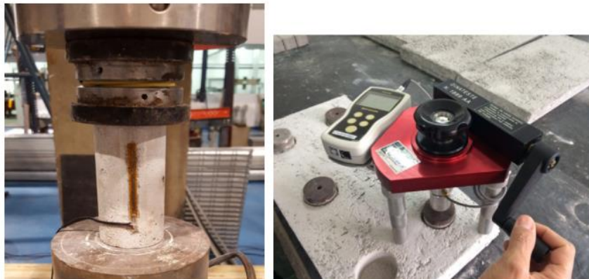
Figura 2 Montagem dos ensaios de (direita) compressão uniaxial e (esquerda) arrancamento
