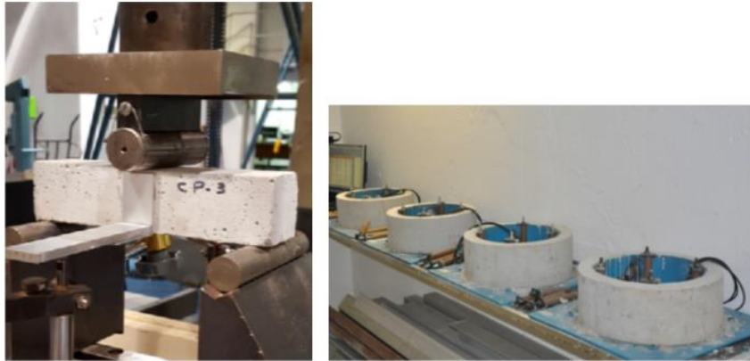
Figura 3 Montagem e instrumentação dos ensaios de (direita) flexão em quatro pontos e (esquerda) retração com restrição
